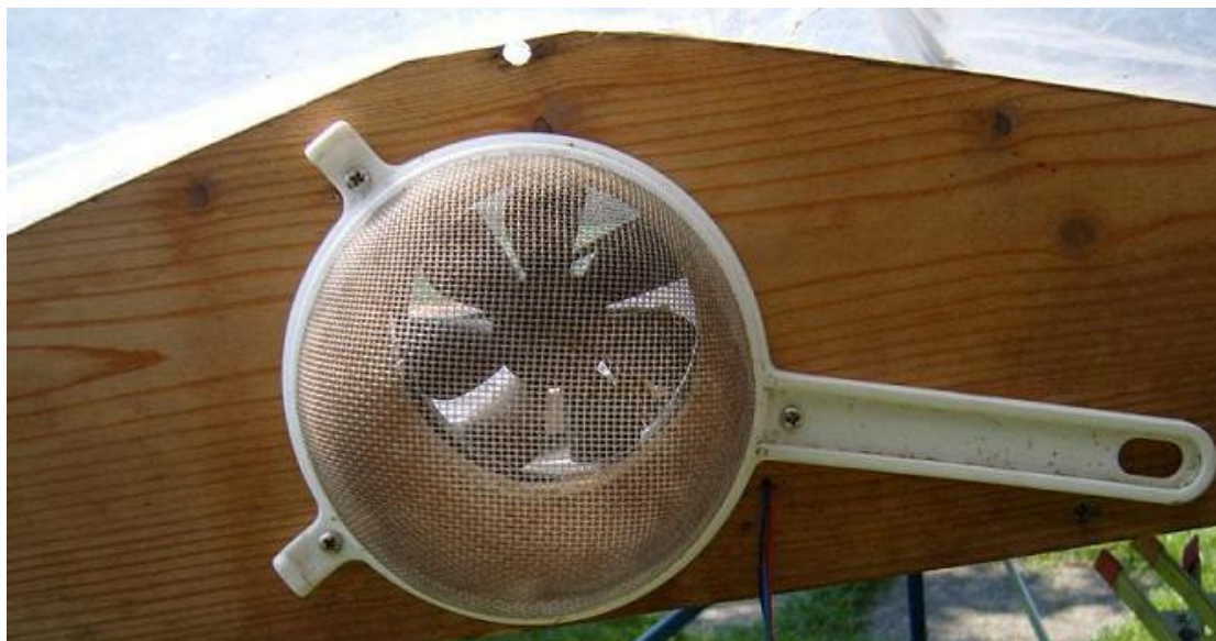
Fig 10 : Abdeckung des Ventilators
